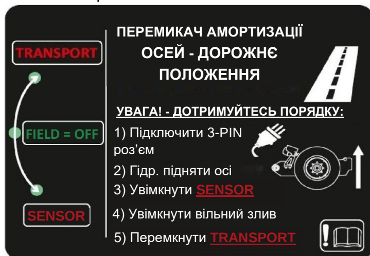
Мал. 51 Блок керування амортизацією - дорожнє положення
