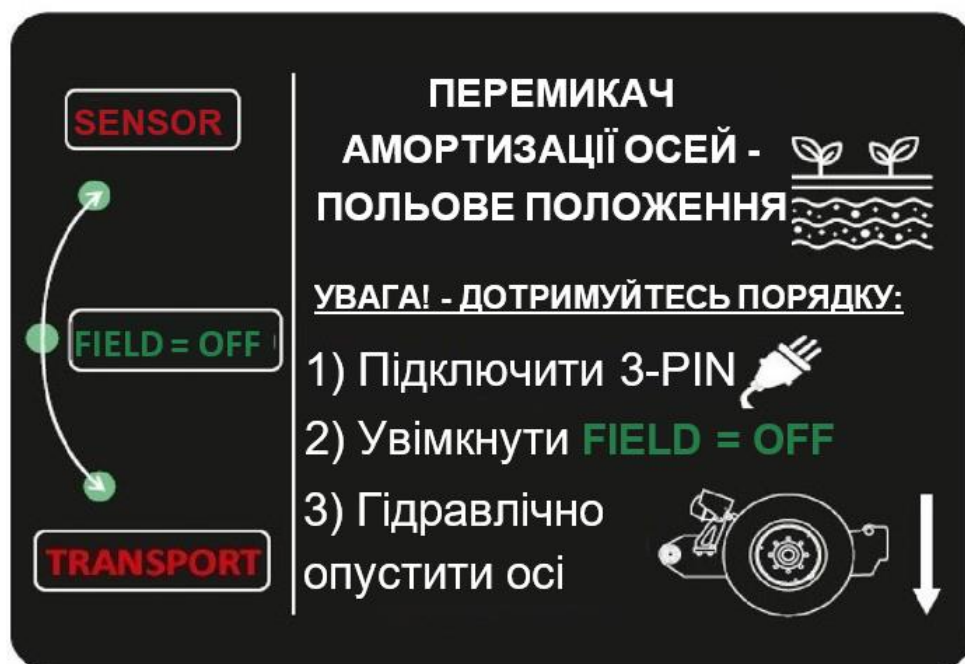
Мал. 94 Інструкція перемикача амортизації осей на полі
