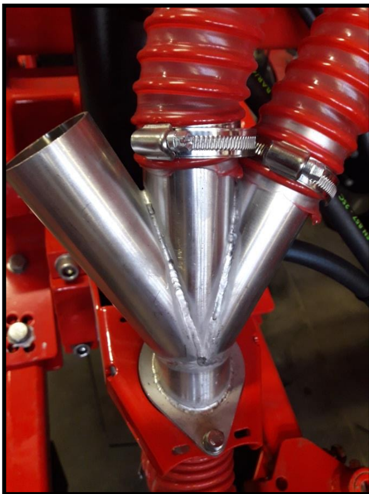
Мал. 65 Приєднання шлангів для добрив до розподільника робочої секції
