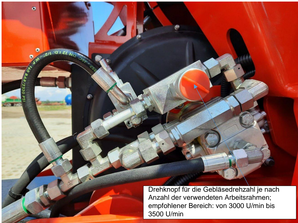
Abb. 58. Vordere Drehzahlregelung
