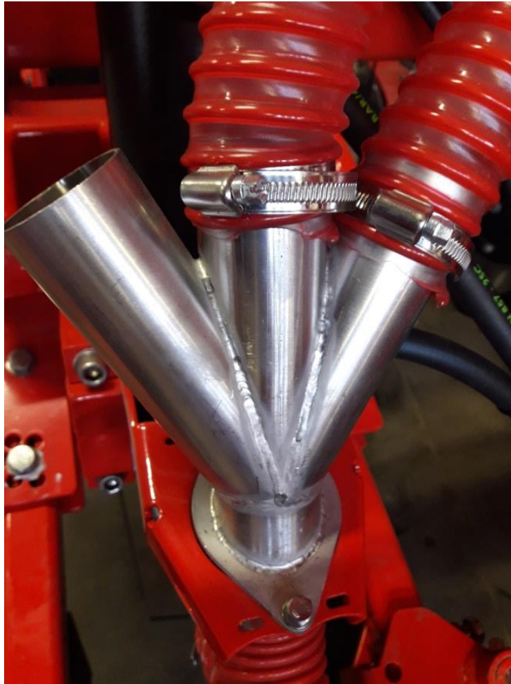
Abb. 52. Anschluss der Düngerschläuche an den Verteiler der Arbeitseinheit
