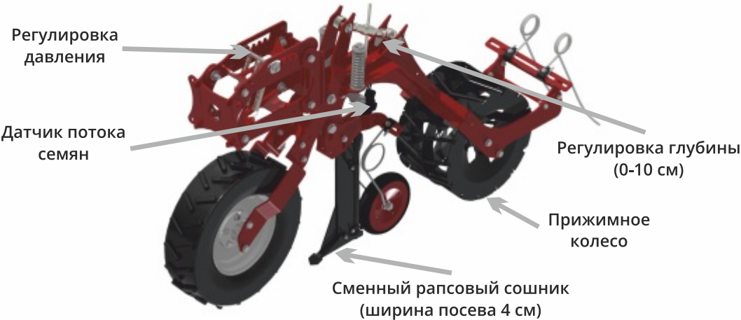
Схема рабочей секции приставки Czajkowski PS
