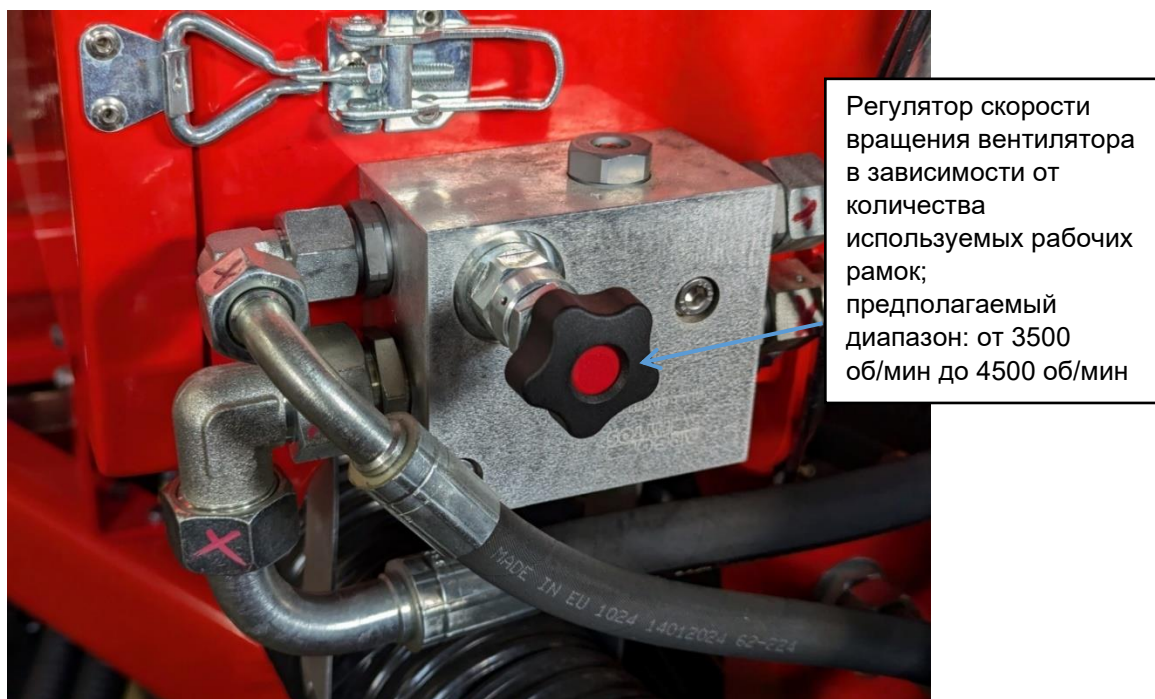
Рис. 42. Система регулировки скорости вращения вентилятора и вентилятора или ВОМ прицепной машины.
