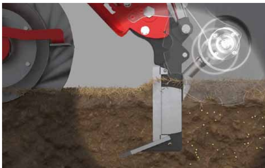
Rys. 3. Pionowa słupica spulchniająca z dyszą do rzędowej aplikacji nawozu (jednego lub dwóch) (Foto: M. Czajkowski)
